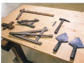
(左から) 施工準備に使用する道具(平瓦谷深選別用、軒丸選別用)や、施工時に使用する勾配定規、タガネ、瓦葺金槌、スルメコテ。
